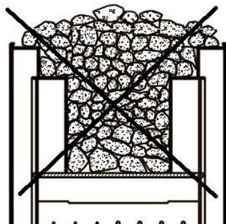
Размещение камней, поперечное сечение отсека для камней в нагревателе
