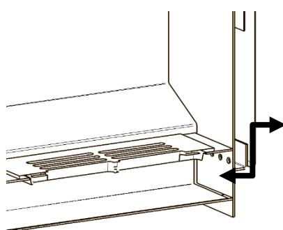
För att aggregatet ska fungera på bästa sätt ska asklädan tömmas efter varje användning för att hålla ventilationsöppningen under gallret öppen och möjliggöra luftinsläpp i ugnen.
